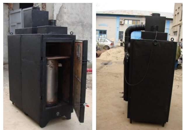
Fig. 17. Hot air generator, 24 kW
